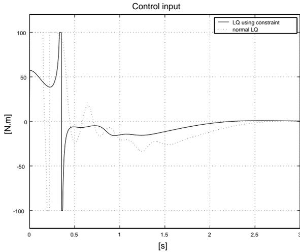
Fig. 13. Control Input (Furuta pendulum)
