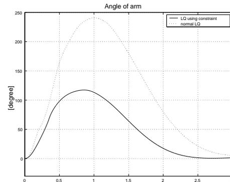
Fig. 11. Arm Angle (Furuta pendulum)
