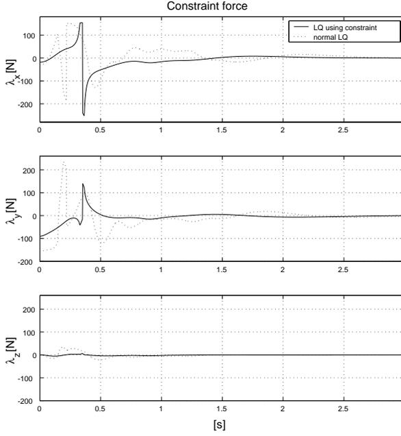
Fig. 12. Constraint Force (Furuta pendulum)
