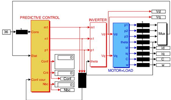
Fig. 7. SIMULINK scheme
