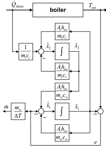
Fig. 4. Estimating  $\dot{m}$  with a parameter observer.
