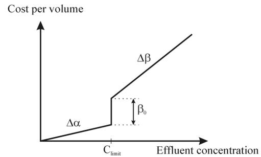
Fig. 2. Cost function for effluent fines.
