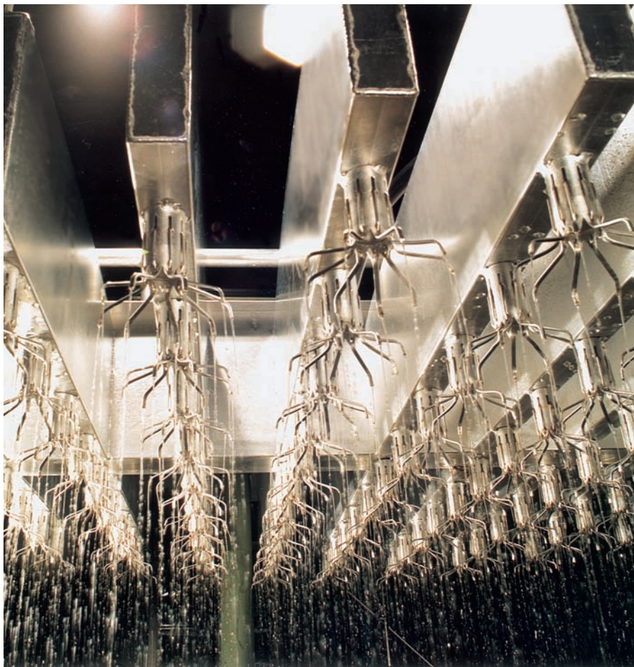
◀ Montz- Flüssigkeitsverteiler Typ S aus Aluminium Durchmesser 2400 mm ausgelegt für 100 l/(m 2 h) bis 750 l/(m 2 h)
