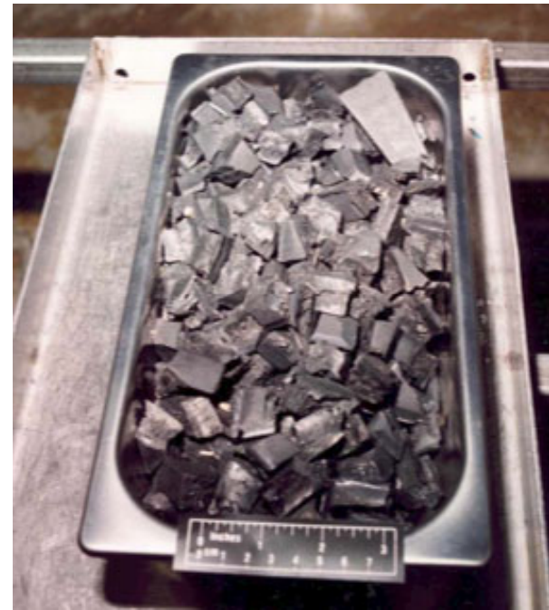
HEU Broken Metal
