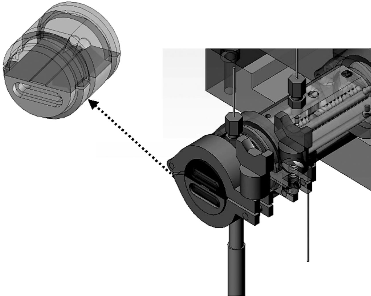
Slit die of the mini twin screw extruder
