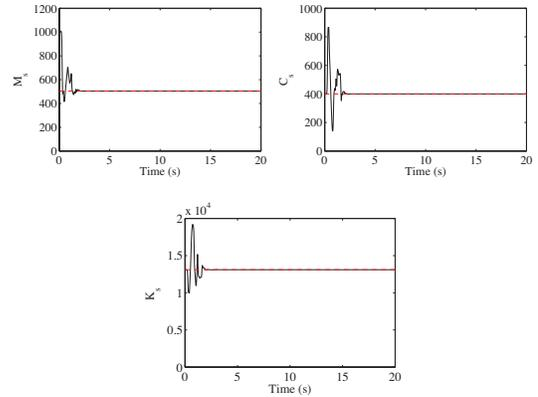
Fig. 6. Convergence of suspension parameter estimates.
