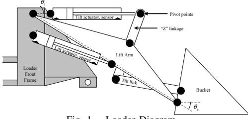
Fig. 1. Loader Diagram
