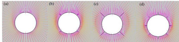
Figure 7 velocity vector field: (a) plain tube, (b) fin4-1mm, (c) fin4-3mm, (d) fin8-1mm
